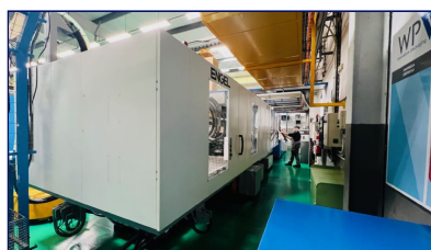
Inyectora Bimateria 550 ton. Con mesa giratoria ENGEL DUO 1800H/1050M/550 pico combi M
