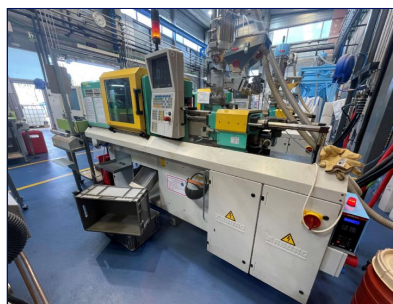
Inyectora termoplástico 25 ton.
